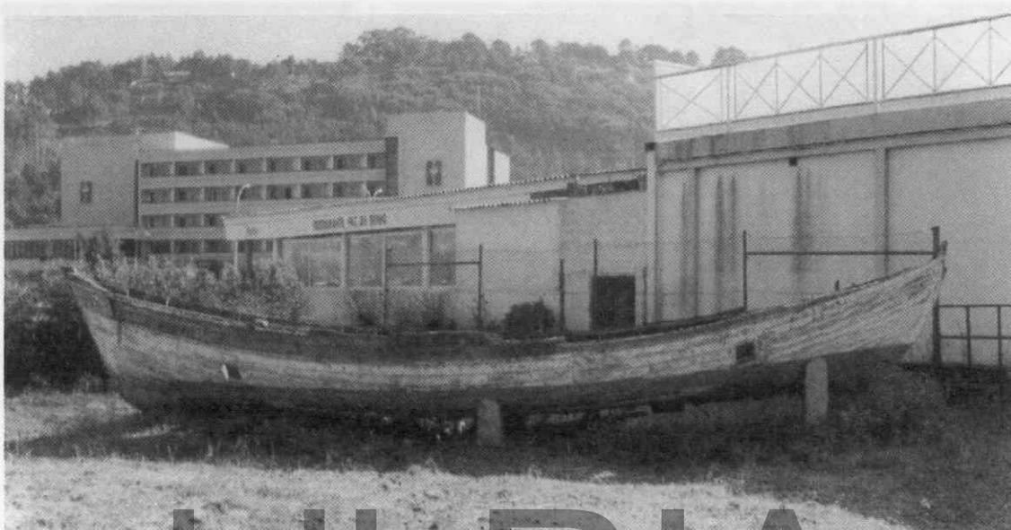
**O FIM DE UMA EMBARCAÇÃO CONSTRUÍDA EM CASCO TRINCADO** — Uma construção que exigia muita técnica e perícia, as madeiras eram sobrepostas e rebitadas com pregos e anilhas em cobre. Foi um salva-vidas de Vila Praia de Âncora. Está abandonado à sua sorte junto do último estaleiro da Foz do Minho em caminho, há vários anos. Fotografado em Maio de 2000.
