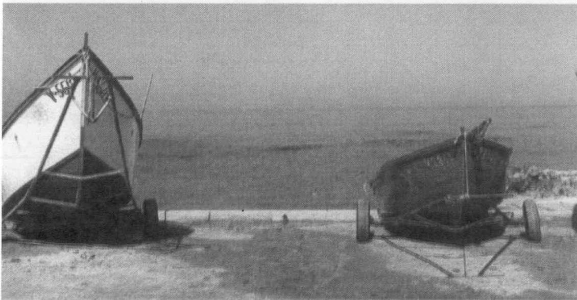
**PRAIA DO CASTELO DO NEIVA — VIANA DO CASTELO DUAS FORMAS DE EVOLUÇÃO NA COSTRUÇÃO** — À esquerda, um Caico com popa de painel ou bote. Embarcação construída a partir da ossada de casco de tabuado liso, com quilha, roda de proa e popa de painel para a colocação do motor fora de borda. À direita, uma voadora, embarcação mais recente, aparecem por meados dos anos 80, construída em contraplacado marítimo, portanto mais leve, de fácil construção e manutenção.
